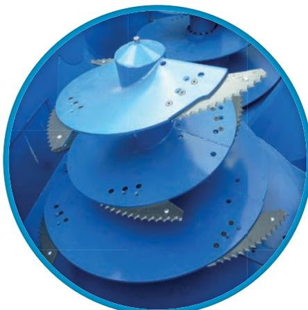
La spire lisse et la base triangulaire permettent des cycles montée-descente rapides du fourrage dans la cuve de la mélangeuse. Le résultat est un temps de mélange réduit de 50% - ce qui limite la consommation électrique, l'usure du matériel, préserve la structure des fourrages et double la capacité de la cuisine.
