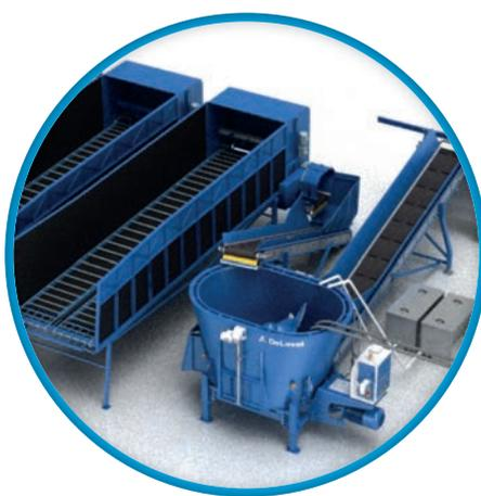
Avec des capacités de 8 m<sup>3</sup> à 22 m<sup>3</sup>, ces mélangeuses robustes sont équipées d'une balance précise sur laquelle on peut programmer plusieurs recettes d'aliments. La vis de la mélangeuse, alimentée par un moteur électrique, hache et mélange efficacement différents aliments pour produire une préparation constante, légère et appétente. De cette manière, les vaches peuvent moins trier et manger les aliments les plus appétissants.
